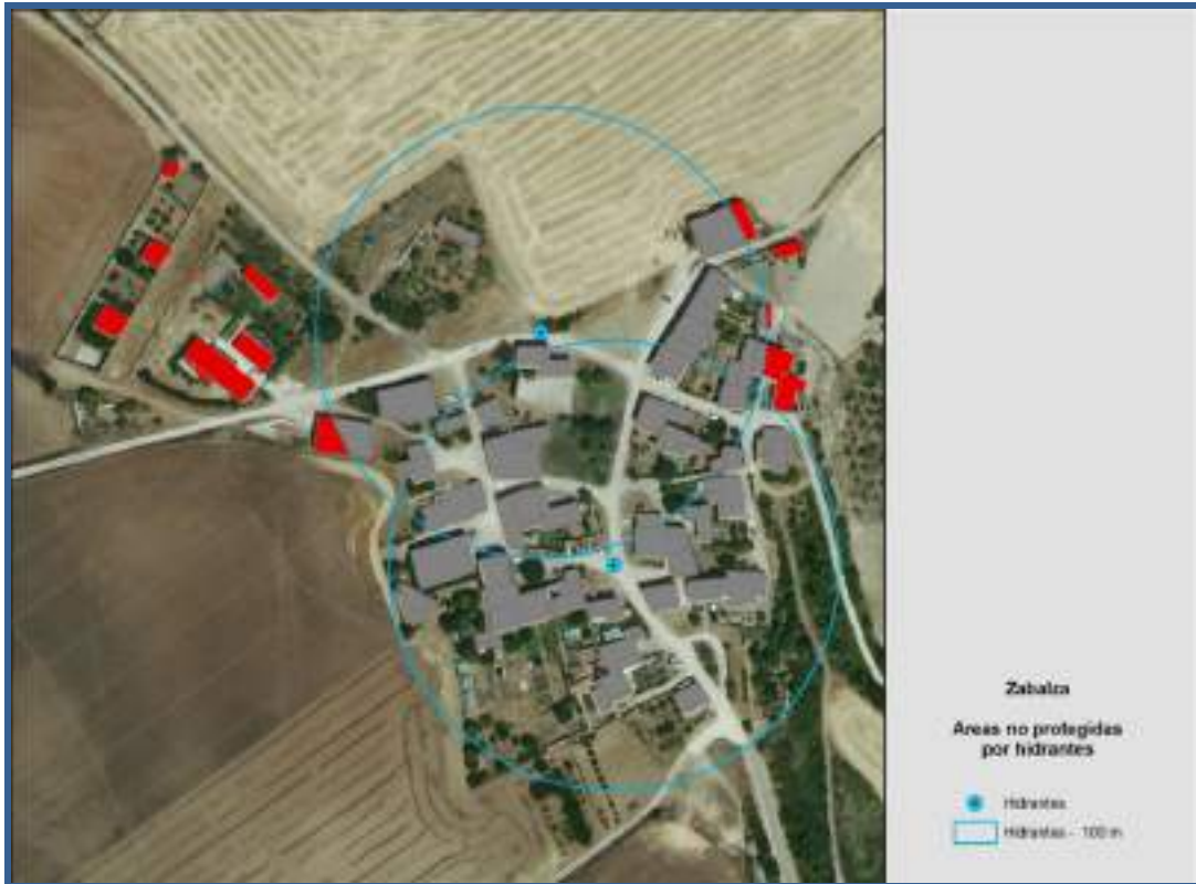
Ilustración 68. Viviendas no protegidas por hidrantes en Zabalza.
