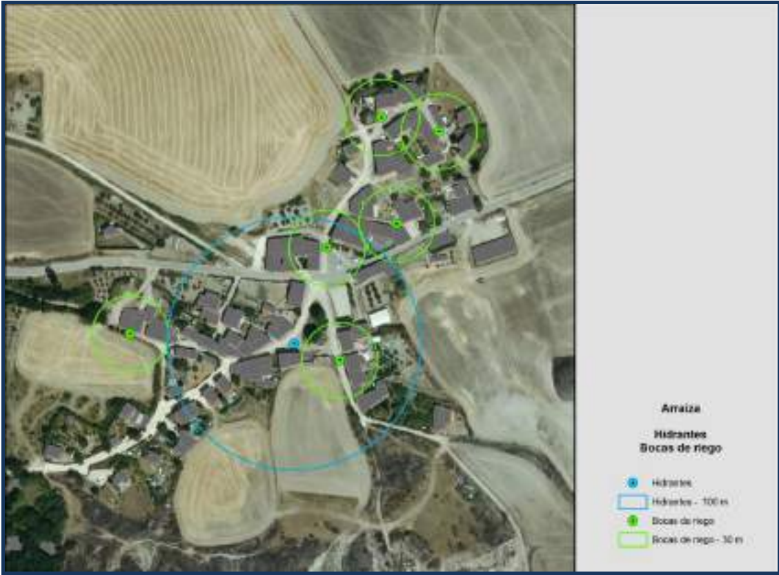
Ilustración 49. Hidrantes y bocas de riego en Arraiza.
