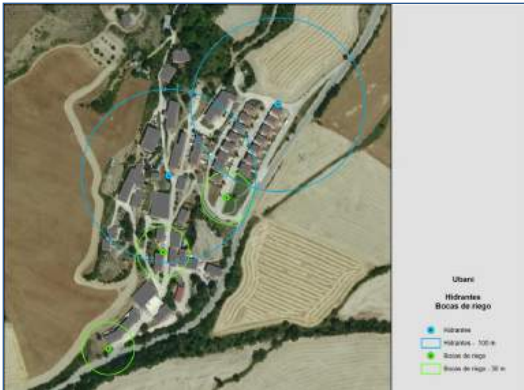
Ilustración 51. Hidrantes y bocas de riego en Ubani.
